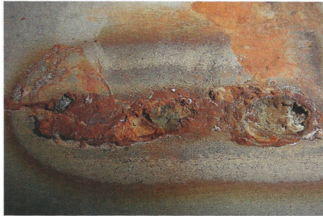
Gravierendes Schadensbild durch MIC (Microbioally Influenced Corrosion) an der Schweißnaht zwischen hoch legierten Stählen
